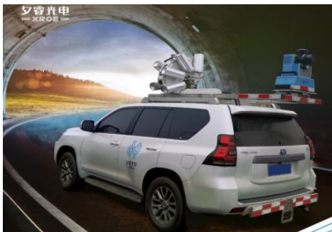
公路隧道检测
