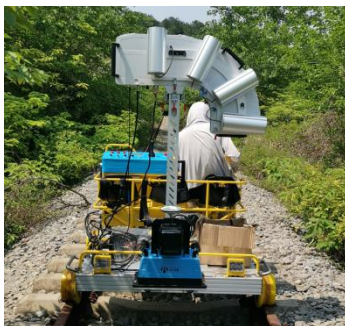
大机捣固清筛测量
