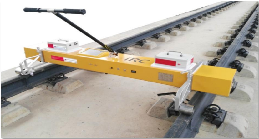
扣件安装状态检查装备
