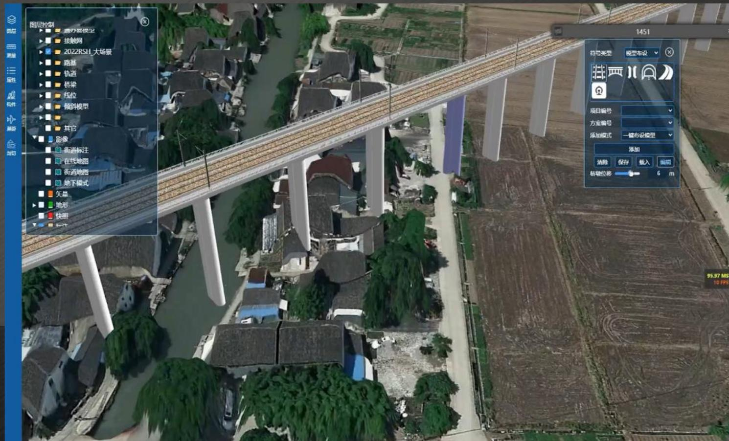
基于三维GIS系统的交互式设计，快速构建数字孪生工程，直观表达铁路工程周边环境模型，辅助开展设计。
