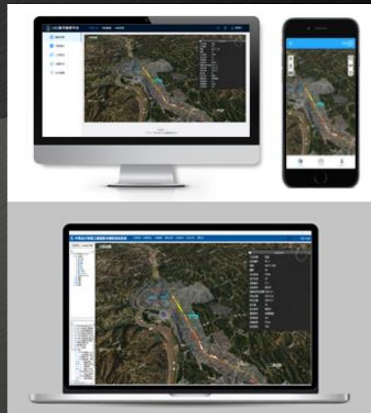
基于三维GIS系统的空间分析功能，分析铁路沿线工程条件，辅助铁路**勘察选线**。根据孪生模型可查看地形起伏、地层信息，精准计算土方填挖量，利用**空间量测**、**分析**绕开不良地质条件区域以及准确确定桥隧站等控制性工点，**提升选线效率和质量**。
